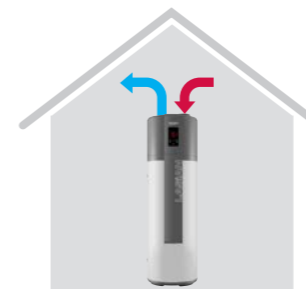
Entrada y salida de aire directa del local donde está instalado
