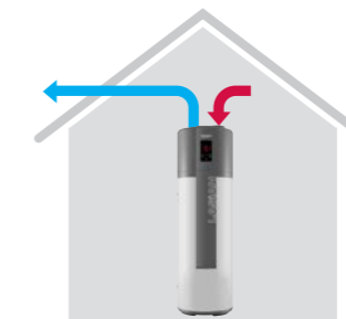
Entrada directa del local donde está instalado y salida canalizada al exterior
