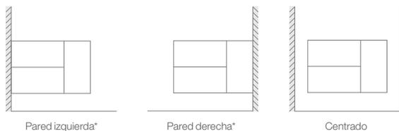
\* Para instalación a pared derecha o izquierda es necesario añadir la tapeta lateral.
