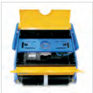
Acceso al filtro
