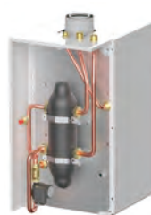
Kit botella de equilibrio Profundidad del kit 250 mm. Ida/retorno 1" 1/2. Conexión gas 1".
