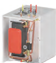
Kit intercambiador de placas Profundidad del kit 300 mm. Ida/retorno 1" 1/4. Conexión gas 3/4".
