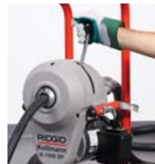
Suelte la empuñadura, el cable se detiene al instante
