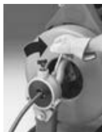
Retroceso del cable
