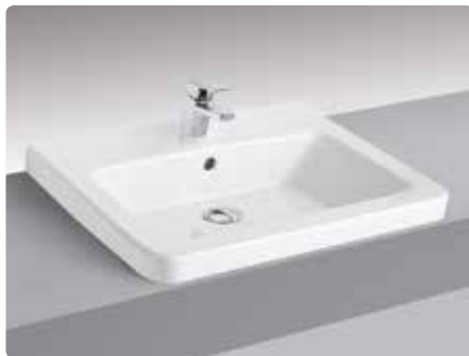
05045 Lavabo de 55 x 45 cm Con rebosadero Instalación de encimera pegado a pared Plantilla de corte de 48,7 x 41,8 cm
