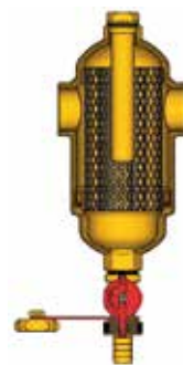
Esquema montaje accesorio: Desfangador + Sep. Magnético
